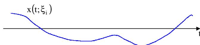
Figura 1.5: Amostra gerada por uma fonte analógica em tempo contínuo
