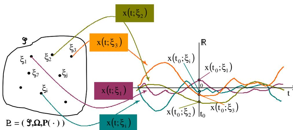
Figura 3.1: Modelação de um processo estocástico
