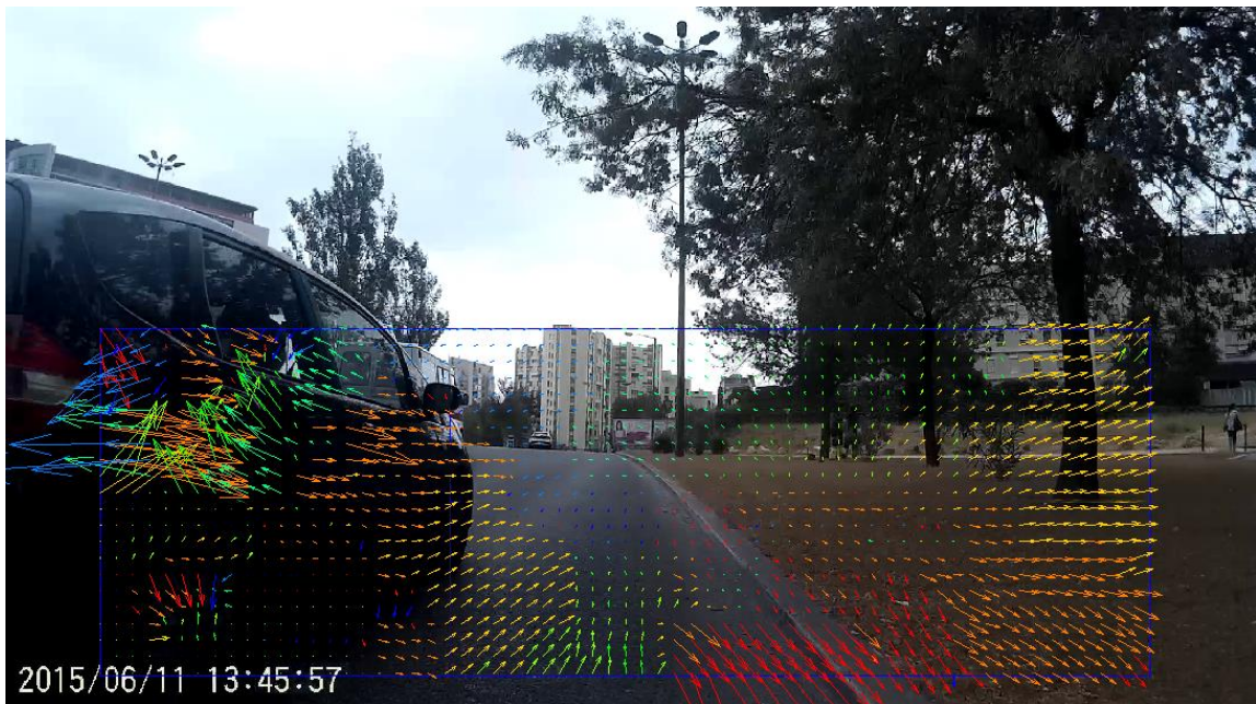
Figura 3.1.9 – Optical flow resultante do método tradicional entre duas imagens.
