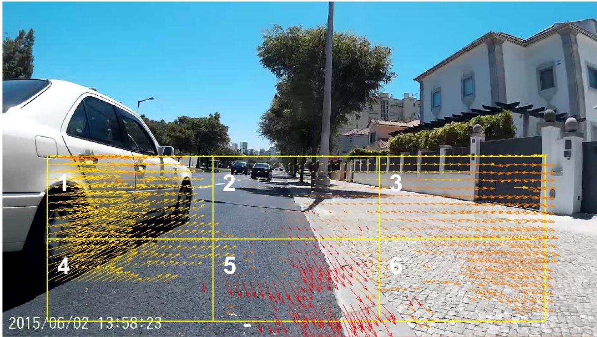
Figura 3.1.12 – Divisão da janela de análise do optical flow .
