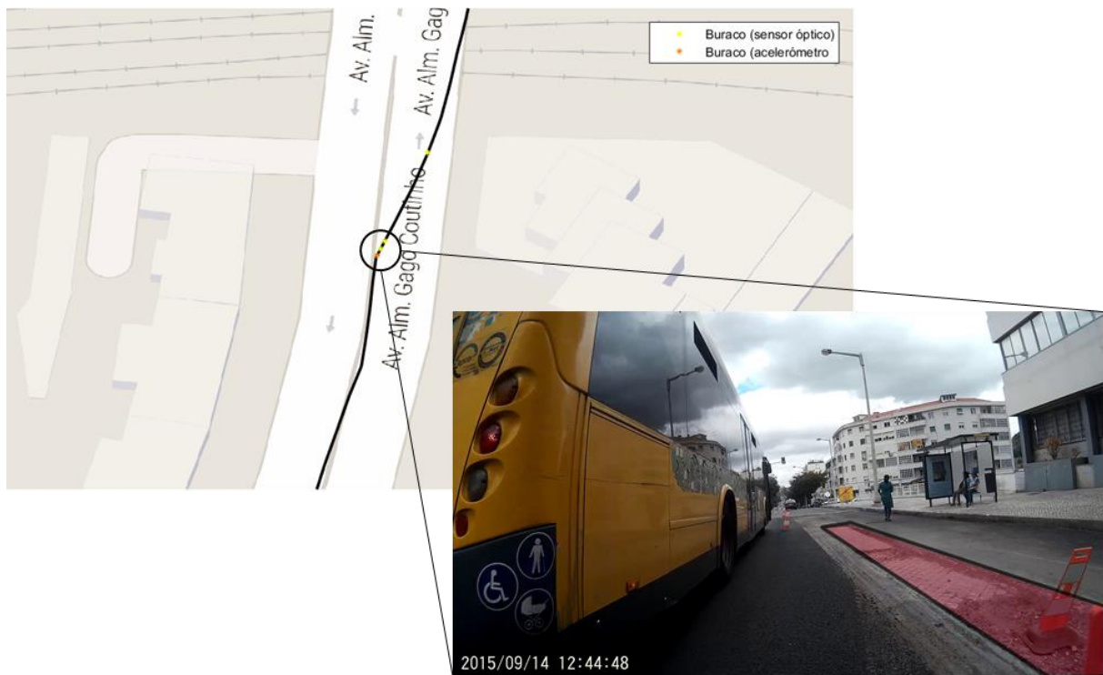
Figura 4.1.8 – Irregularidade na via detectada por ambos os métodos: desnível na estrada devido a remoção do alcatrão.
