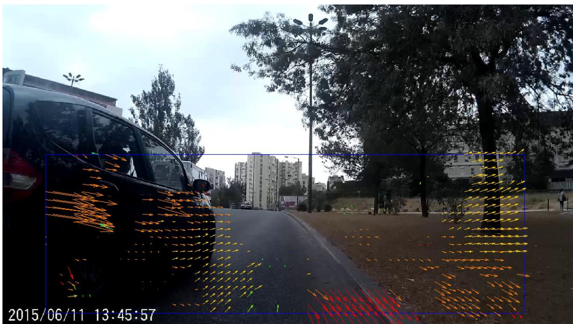
Figura 3.1.10 – Optical flow resultante do método adoptado entre três imagens.
