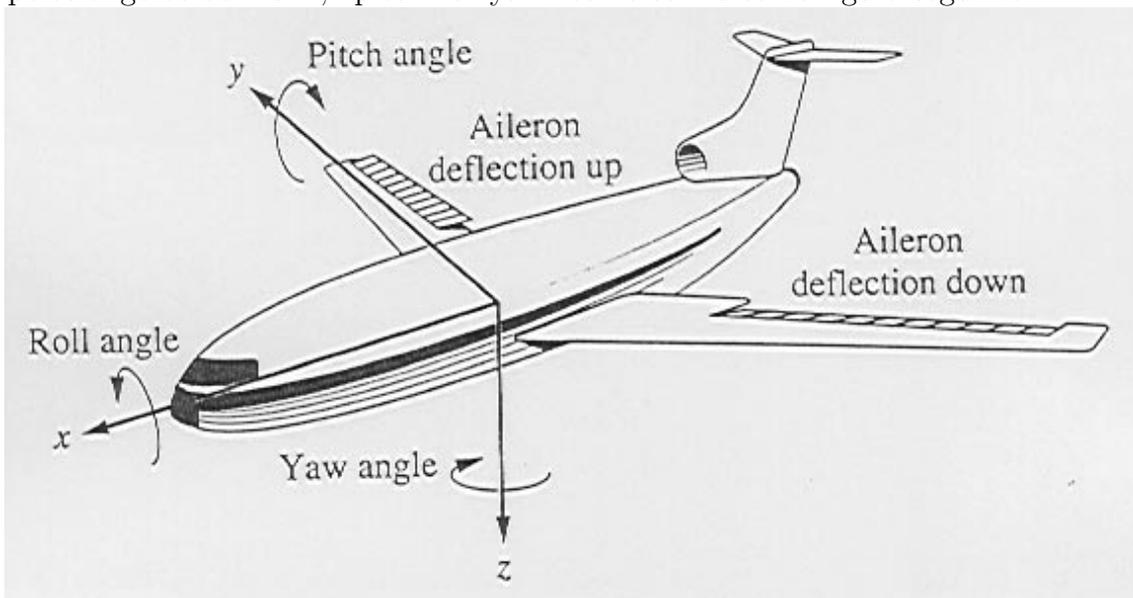
Desenhe um diagrama de blocos de um sistema em cadeia fechada que estabilize o ângulo de “roll” da seguinte maneira: o sistema mede o ângulo actual com um giroscópio e compara o seu valor com valor desejado. Os “aileron” respondem ao erro no ângulo de “roll” através de uma deflexão. O avião responde a esta deflexão angular com uma variação do ângulo de “roll”. Identifique os transdutores de entrada e saída, o controlador e o sistema a controlar. Identifique também o tipo dos sinais presentes.
