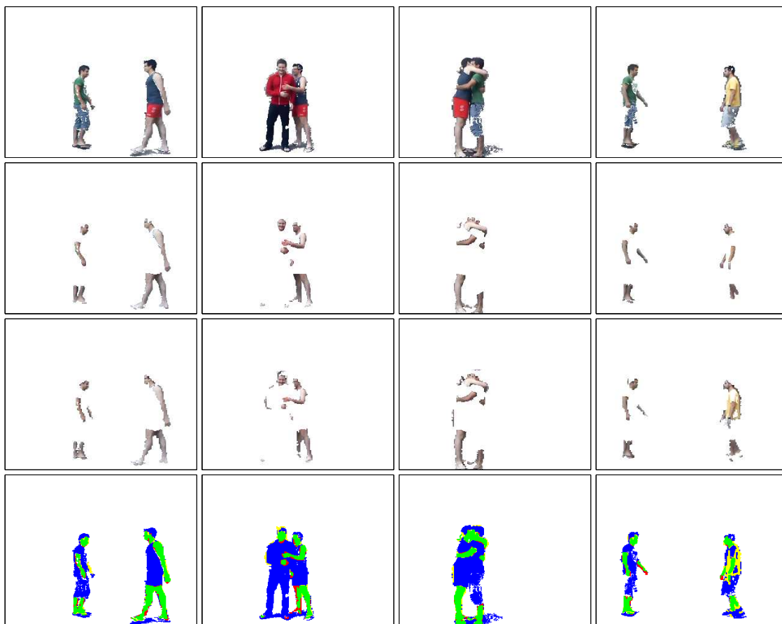
Figura 3.16: Exemplo avaliação da detecção de pele: (1ª linha) entrada, (2ª linha) pele real, (3ª linha) pele detectada, (4ª linha) classificação dos pixeis, onde as cores verde, azul, vermelho e amarelo correspondem a verdadeiro positivo, verdadeiro negativo, falso negativo e falso positivo, respectivamente.
