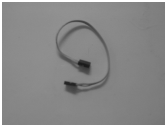
Figura 31 – Cabo para efectuar ligação entre portos do micro controlador e Terminal para Módulos de Potência.
