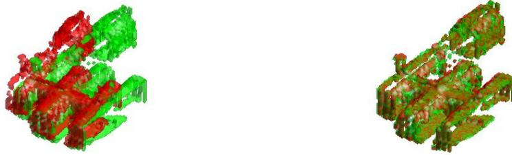
**Figura 44 - ICP -** a) Volumes de galerias romanas desalinhadas. O volume representado a vermelho foi sintetizado por aplicação da transformação geométrica T1 ao volume original a verde
