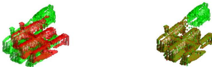
**Figura 58 - SRIN -** a) Volumes de galerias romanas desalinhadas. O volume representado a vermelho foi sintetizado por aplicação da transformação geométrica T3 de corpo rígido ao volume
