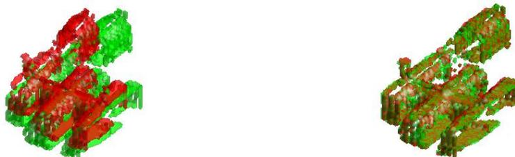
**Figura 46 - ICP - a) Volumes de galerias romanas desalinhadas. O volume representado a vermelho foi sintetizado por aplicação da transformação geométrica T2 ao volume original a verde
