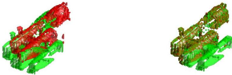
Figura 59 - SRIN - a) Volumes de galerias romanas desalinhadas. O volume representado a vermelho foi sintetizado por aplicação da transformação geométrica T4 de corpo rígido ao volume original a verde e retirando-lhe CP
