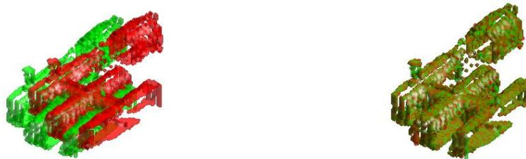
**Figura 56 - SRIN -** a) Volumes de galerias romanas desalinhadas. O volume representado a vermelho foi sintetizado por aplicação da transformação geométrica T3 de corpo rígido ao volume original a verde.
