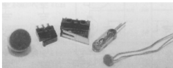
Figura 3.12. Conjunto sensorial básico de un robot. De izquierda a derecha: micrófono, microinterruptor, sensor de mercurio y fotocelda.
